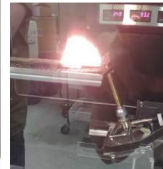
Flame test: UL 94 V (2013-03) / DIN 4102
