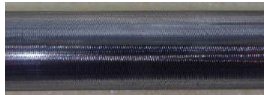
Fibers: Tungsten Matrix: Copper, Tungsten, ....
